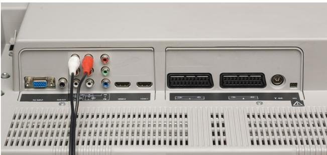
Über den LINE OUT Anschluss haben Sie die Möglichkeit das Audiosignal Ihres LCD-TV's über einen Verstärker wiederzugeben. Schließen Sie dazu ein Cinch-Kabel an.
