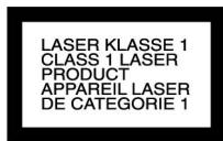
Der DVD-Spieler ist ein Laserprodukt der Klasse 1. Das Gerät ist mit einem Sicherheitssystem ausgerüstet, das das Austreten von gefährlichen Laserstrahlen während des normalen Gebrauchs verhindert. Um Augenverletzungen zu vermeiden, manipulieren oder beschädigen Sie niemals das Sicherheitssystem des Geräts.
