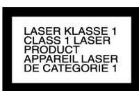
Le lecteur DVD est un produit laser de classe 1. L'appareil est équipé d'un système de sécurité qui empêche la fuite de rayons laser dangereux au cours d'une utilisation normale. Pour prévenir tout risque de blessure des yeux, prenez garde de ne jamais manipuler ni abîmer le système de sécurité de l'appareil.
