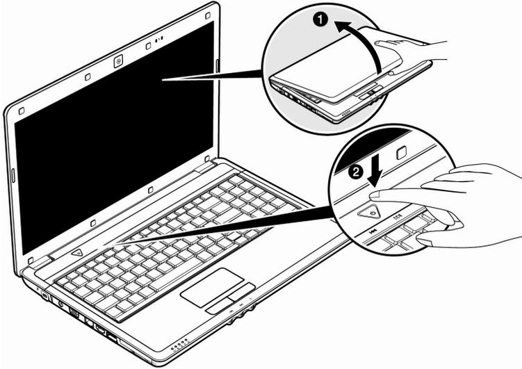
Die Betriebsanzeige informiert Sie über den Betriebszustand. Unabhängig vom Betriebssystem wird das Notebook ausgeschaltet, wenn der Schalter länger als 4 Sekunden ununterbrochen betätigt wird.
