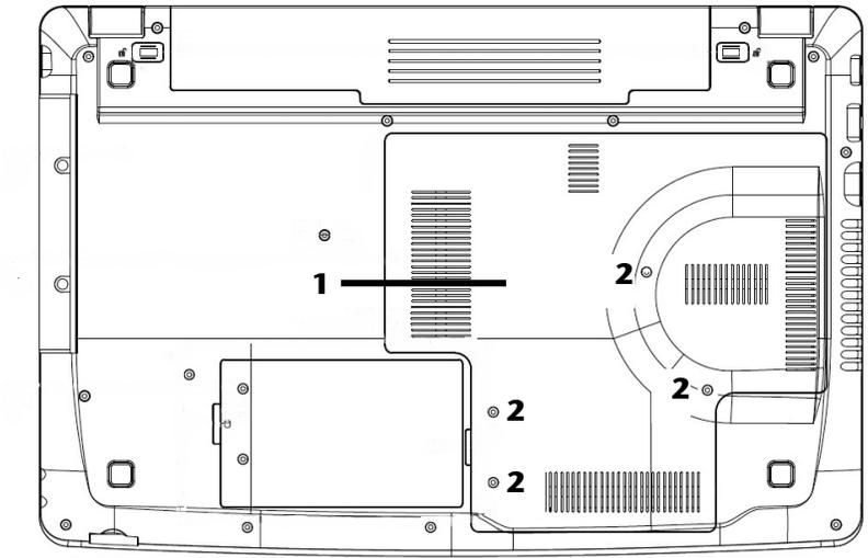
2. Entfernen Sie die Festplattenabdeckung (1) des Festplattenschachts, indem Sie die vier Schrauben (2) lösen und die Festplattenabdeckung mit einem Schraubendreher anheben und abnehmen.
