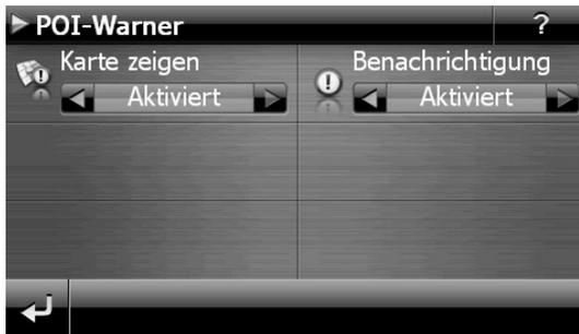
Der akustische Hinweis auf einen Verkehrsüberwachungspunkt erfolgt durch einen Warnton ca. 15 Sekunden vor Erreichen des Überwachungspunktes. Ein doppelter Warnton erfolgt dann noch einmal ca. 7 Sekunden vorher. Ein vierfacher Warnton weist auf eine zu hohe Geschwindigkeit hin. Zusätzlich wird durch einen Annäherungsbalken der Abstand zum Überwachungspunkt dargestellt. Beispielsicht bei aktivierter Kartendarstellung:
